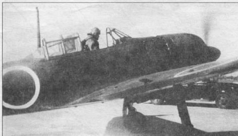
Прогрев двигателя Сакае-21 перед взлетом, истребитель А6М3 модель 32. В кабине нет прицела, из чего можно сделать вывод о тренировочном назначении этого самолета. Окраска - стандартная поздняя схема: темно-зеленый верх и светло-серый низ. Белая окантовка вокруг фюзеляжного хиномару имеет ширину 75 мм.
