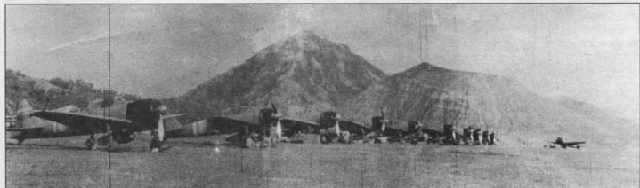
«Zero» модель 21 из авиагруппы авианосца «Дзюкаку», Рабаул, 1943 г. Палубная авиация обеспечивала прикрытие с воздуха эвакуации японских войск с Гуадалканала. Фюзеляжи всех истребителей промаркированы белыми полосами с красными окантовками. Ранее самолеты с «Дзюкаку» идентифицировались по двум полосам белого цвета, нанесенным вокруг фюзеляжа.
