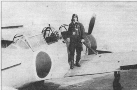
Для улучшения путевой устойчивости по бортам фюзеляжа А6М2-К были смонтированы узкие и длинные кили. На снимке - самолет из Цукуба кокутай, машина целиком окрашена в оранжевый цвет, капот двигателя - черный.
