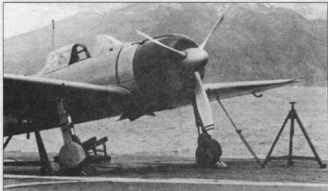
«А1-156» - А6М2 модель 21 раннего выпуска. Истребитель сфотографирован на палубе авианосца «Акаги» в заливе Хитокан на северо-восточном побережье Японии. Отсюда «Акаги» ушел курсом на Перл-Харбор. Обратите внимание - две последние цифры бортового кода самолета продублированы на створке ниши основной опоры шасси и в нижней части капота двигателя. Цифры на створке ниши шасси - черные, на капоте - белые.
