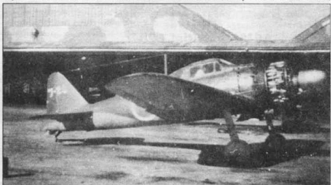
TSU-28 - «Зеро» модель 52b из Цукуба кокутай. В этом тренировочном подразделении готовили летчиков-истребителей, но с увеличением размаха операций бомбардировщиков В-29 к отражению налетов стали привлекать летчиков-инструкторов из Цукуба кокутай. Фонари кабины истребителей модель 52b снабжались лобовыми бронестеклами толщиной 45 мм.
