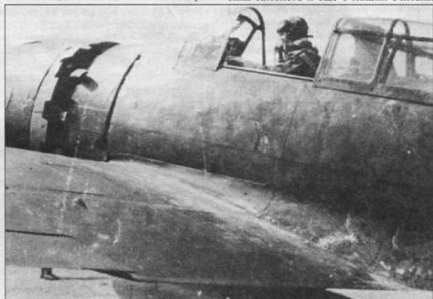
Кабина и средняя часть фюзеляжа «Зеро» модель 52с, снаружи лобового остекления козырька кабины на модели 52с крепилось бронестекло толщиной 45 мм. Стади пилот был защищен бронестеклом толщиной 55 мм.
