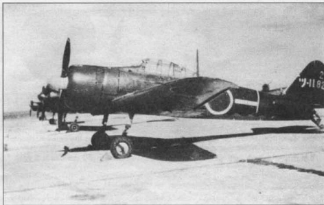
«Zero» модель 21 из Цукуба Кокутай, обратите внимание на отсутствие створок ниш основных опор шасси. Вертикальная и горизонтальная линии на фюзеляже - белого цвета. Граница темно-зеленого и светло-серого цвета - волнистая. Верхние поверхности самолета - темно-зеленые, нижние - светло-серые.
