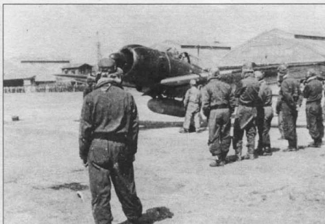
«Зеро» модель 52с из Ятабе кокутай. Под фюзеляжем - топливный бак позднего типа, который подвешивался в четырех точках.
