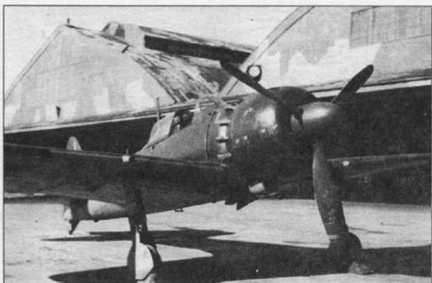
Крыльевые 20-мм пушки демонтированы. Хорошо видны обтекатели пушечных стволов новой формы.
