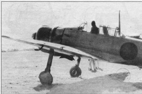
Хорошо виден массивный балансир левого элерона, балансиры устанавливались, начиная с самолета с заводским номером «127».
