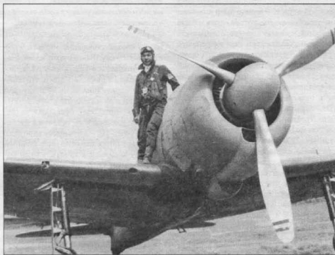
Тот-же самолет. Хорошо видны створки юбки капота в отклоненном положении и выхлопной патрубков. На более поздних вариантах с целью улучшения охлаждения двигателя выхлопной патрубков перенесли выше. В корне крыла виден воздухозаборник для вентиляции кабины летчика. Обратите внимание на «солдатика» - механический индикатор выпущенности положения основной опоры шасси, солдатик отчетливо виден на верхней поверхности левой плоскости крыла.
