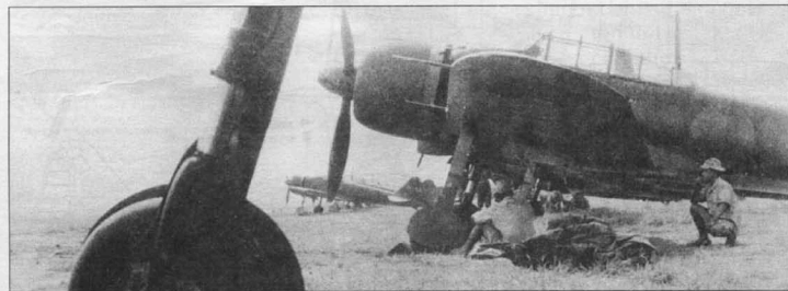
А6М3 модель 22, Рабаул, середине 1943 г. Самолет очень необычен: по носовой части фюзеляжа - однозначно «модель 22», но крыло - от А6М5 модель 52! Не известно, что это такое - полевая модификация или заводской гибрид.
