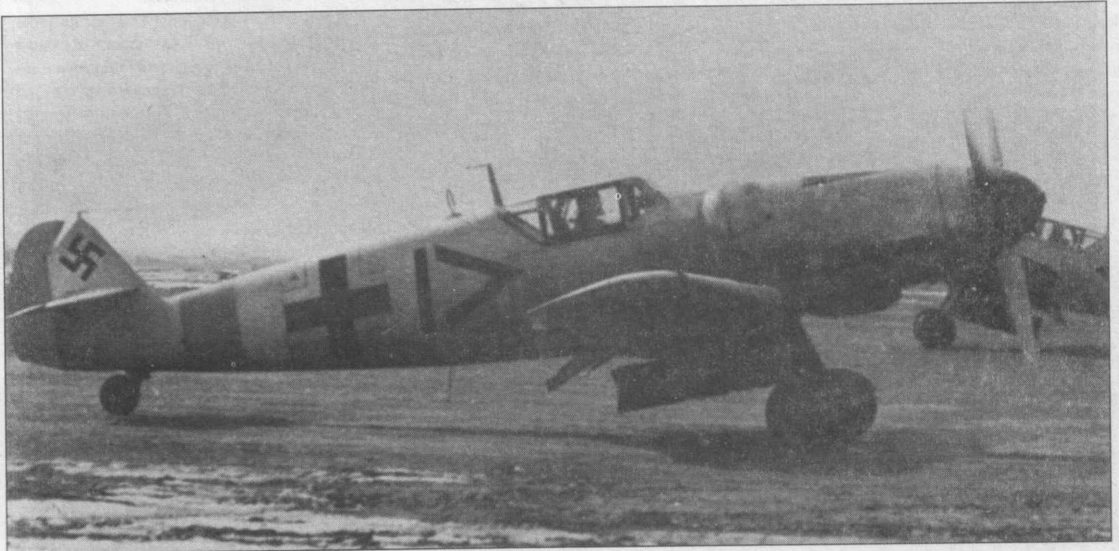
«Густав-5» позднего выпуска, вероятно из JG 54, Восточный фронт. Гитлеровцы широко практиковали переделку истребителей в бомбардировщики. Этот самолет, оснащенный комплектом RI, несет на внешней подвеске бомбу SC 250. Самолет покрыт зимним камуфляжем, обтекатель винта, руль направления и полоса на фюзеляже желтого цвета.
