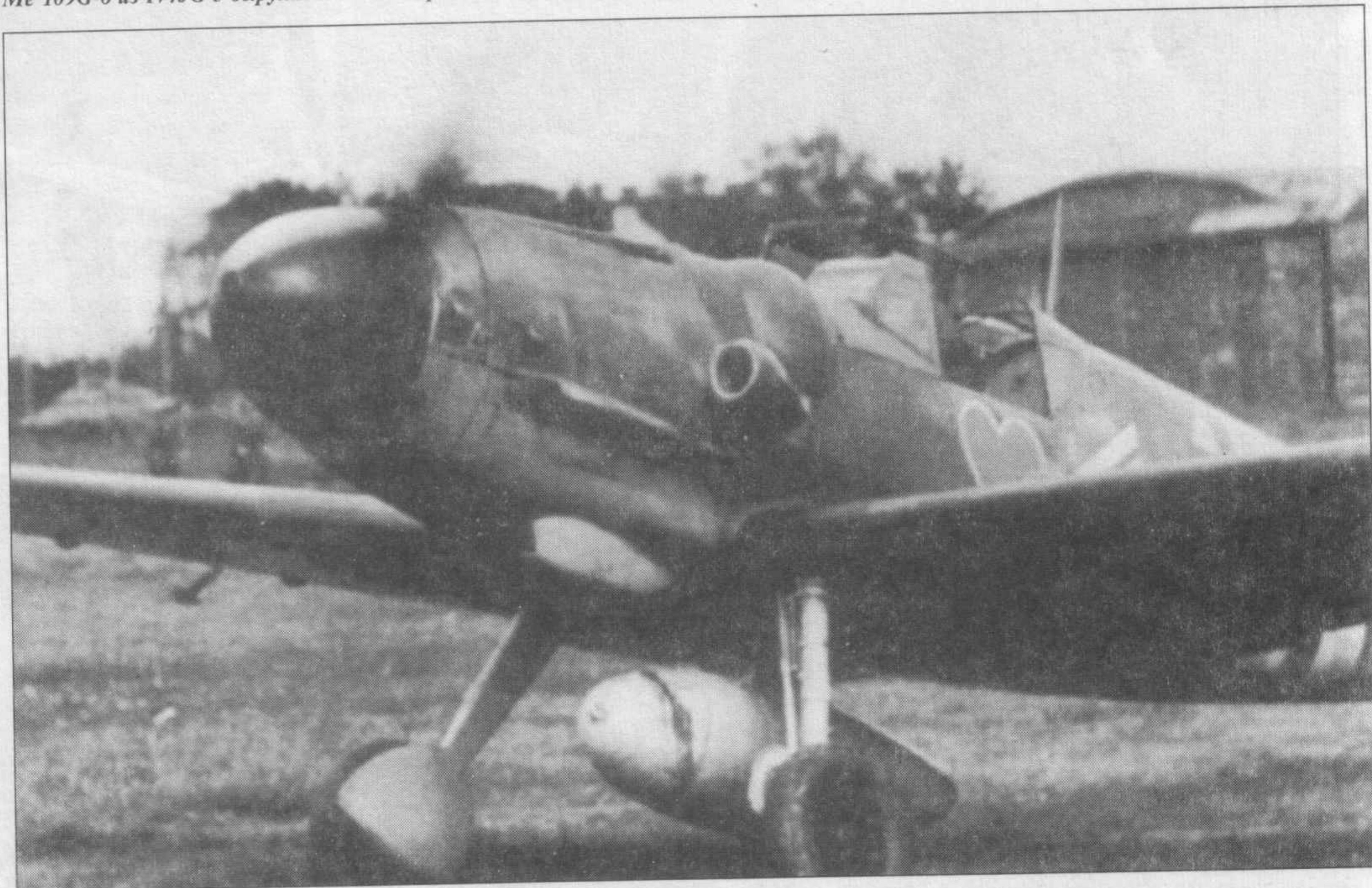
Me 109G-6 из JG 54. Самолет раннего выпуска: без радиопеленгатора и с длинной антенной мачтой. Самолеты, эксплуатируемые на Восточном фронте, долгое время не оснащали радиомаяком FuG 25.
