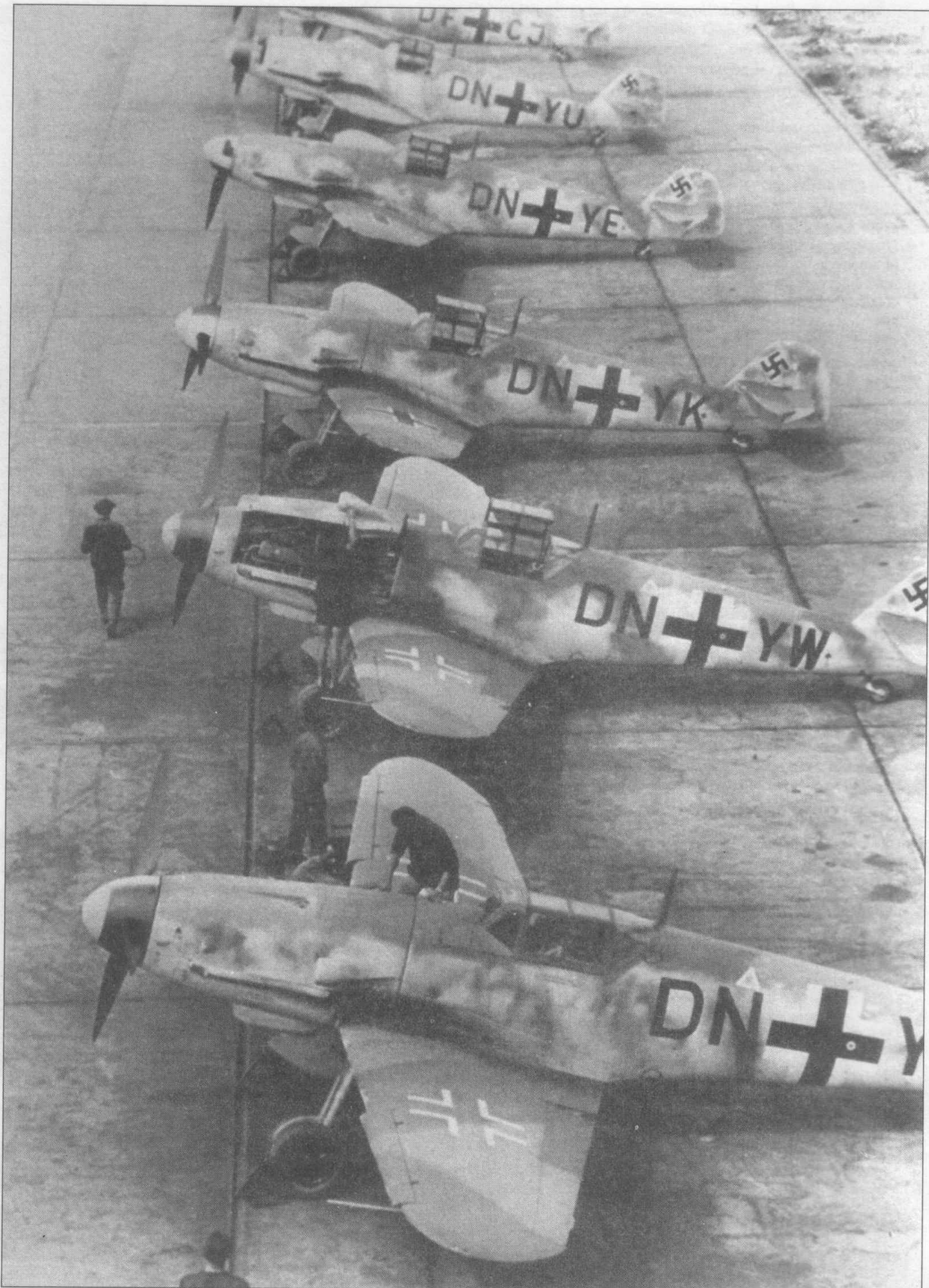
Группа Me 109G-2, готовая к сдаче заказчику. Виден камуфляж и опознавательные знаки. Рисунок на верхней стороне крыльев и фюзеляжа у всех машинах идентичен, а пятна на бортах фюзеляжа располагаются произвольно.
