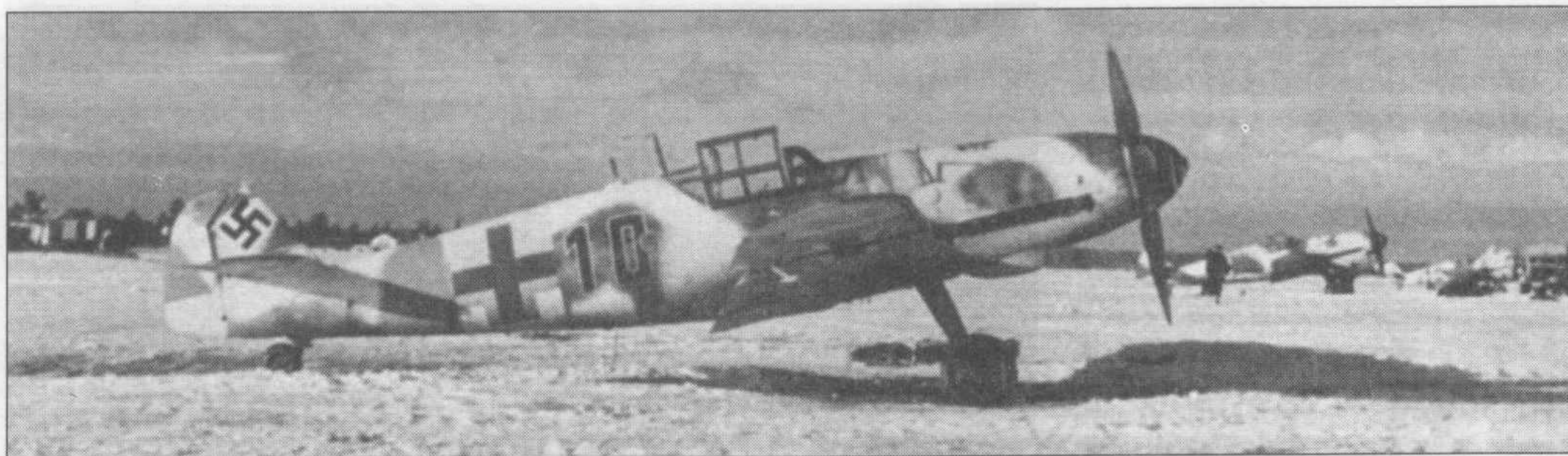
«Густав-6» позднего выпуска из JG 54 стоит на заснеженном аэродроме, Восточный фронт, зима 1943/44 г.г. Из-под белого зимнего камуфляжа проглядывают большие участки стандартного камуфляжа. Нижняя часть руля направления желтая, желтая и полоса быстрой идентификации на фюзеляже. Под выступом правого пулемета на капоте виден небольшой обтекатель маслососа.
