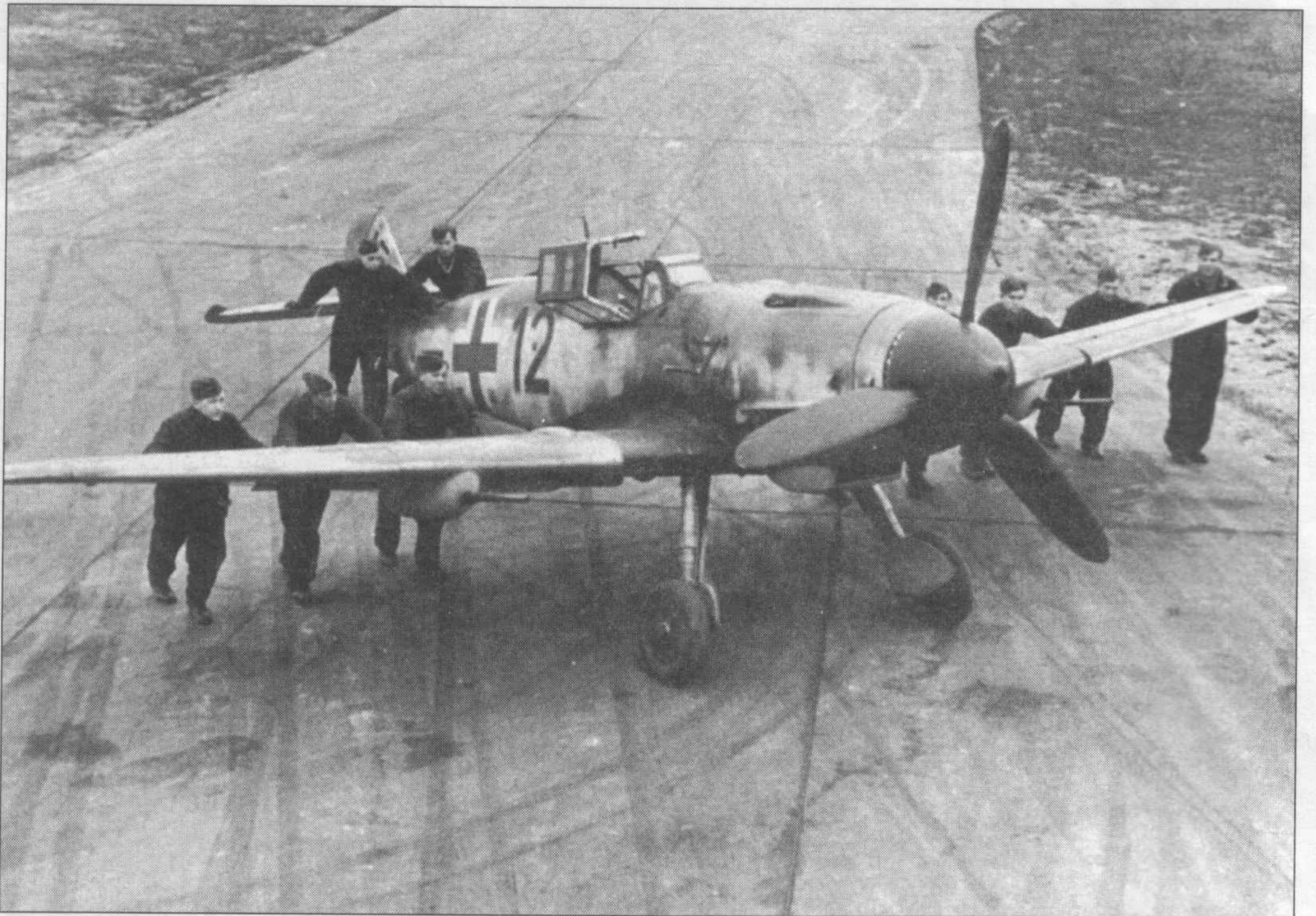
Поздние G-6 отличались укороченной антенной мачтой, наличием пеленгатора и радиомаяка FuG 25. На снимке «тяжелый» G-6 с пушками MG 151/20 под крыльями. Снабжение топливом ухудшалось с каждым днем, поэтому самолеты на взлетные полосы и в ангары закатывали вручную, как поступают с этим Me 109G-6/R6 из II./JG 2. Обратите внимание, возле ручки стартера виднеется небольшой воздузозаборник. Основание крыла и фюзеляж у основания крыла покрашены черной краской.
