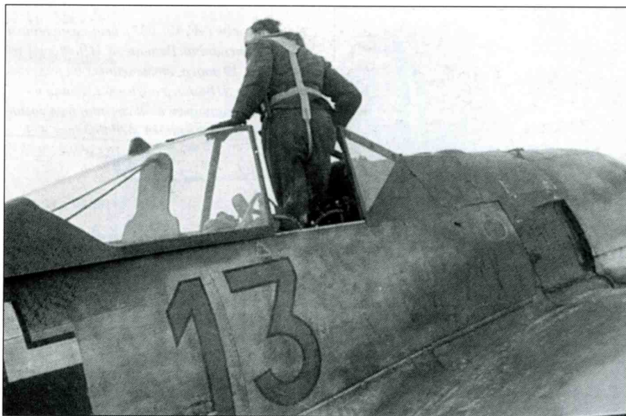
Пилот осторожно втискивается в кабину истребителя. Видны гладкая поверхность основания крыла и двойной упор бронированного изголовья. В задней части капота отсутствуют вентиляционные жалюзи, что указывает на использование двигателя BMW 801C.
