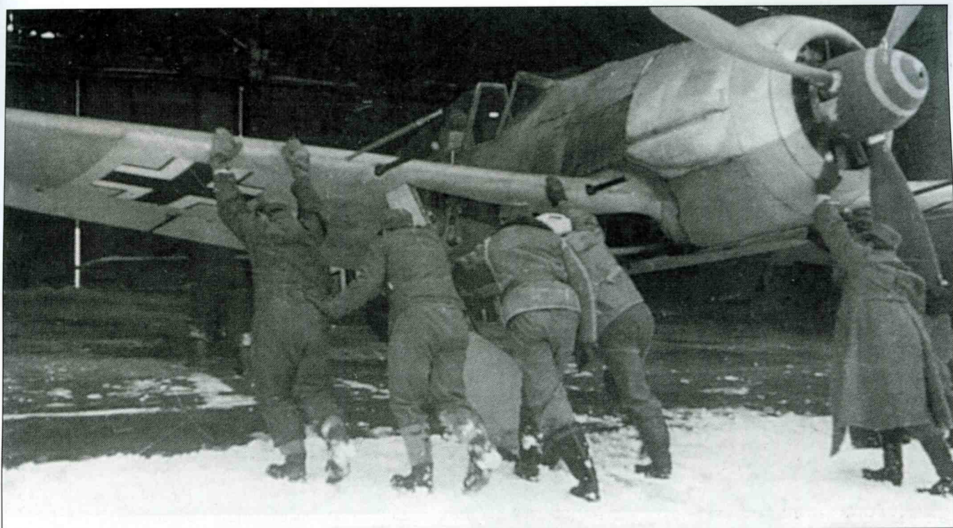
Самолеты Fw 190A-6 отличались усиленными крыльями, в консолях которых стояли 20-мм пушки MG 151/20 вместо стандартных до того времени MG FF.
