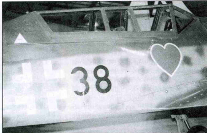
Передняя часть фюзеляжа Fw 190S-8, W.Nr. 584219, Музей Королевских ВВС в Хендоне. Обратите внимание на открытые жалюзи за капотом двигателя. Эмблема JG 54 нанесена уже после войны.
