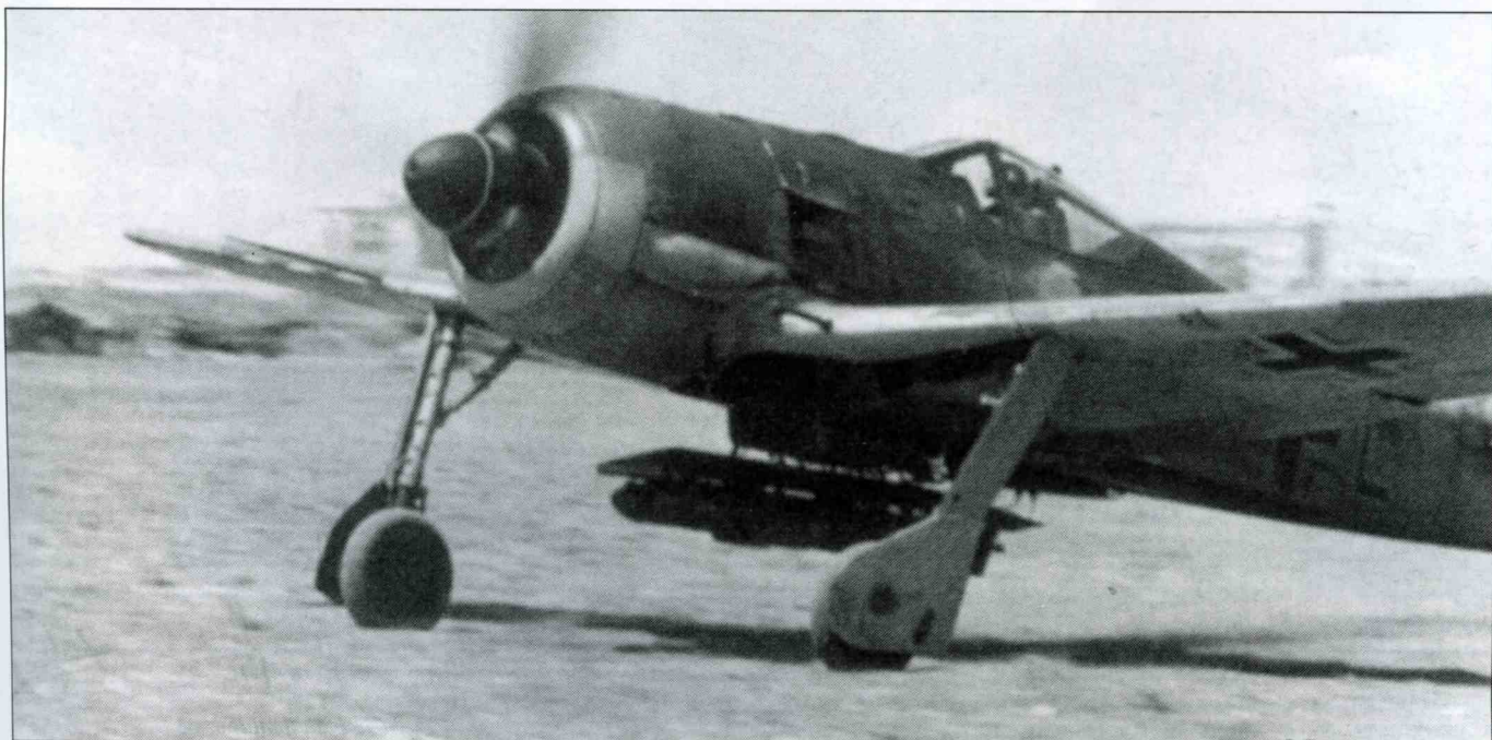
Фв 190F-2 представлял собой развитие Фв 190А-5/У3. Эти два варианта машин почти неотличимы друг от друга. Самолеты могли нести на бомбодержателе ETC 501 адаптер ER 4 (Einhaengerost 4), позволявший брать четыре 50-кг бомбы SC 50.
