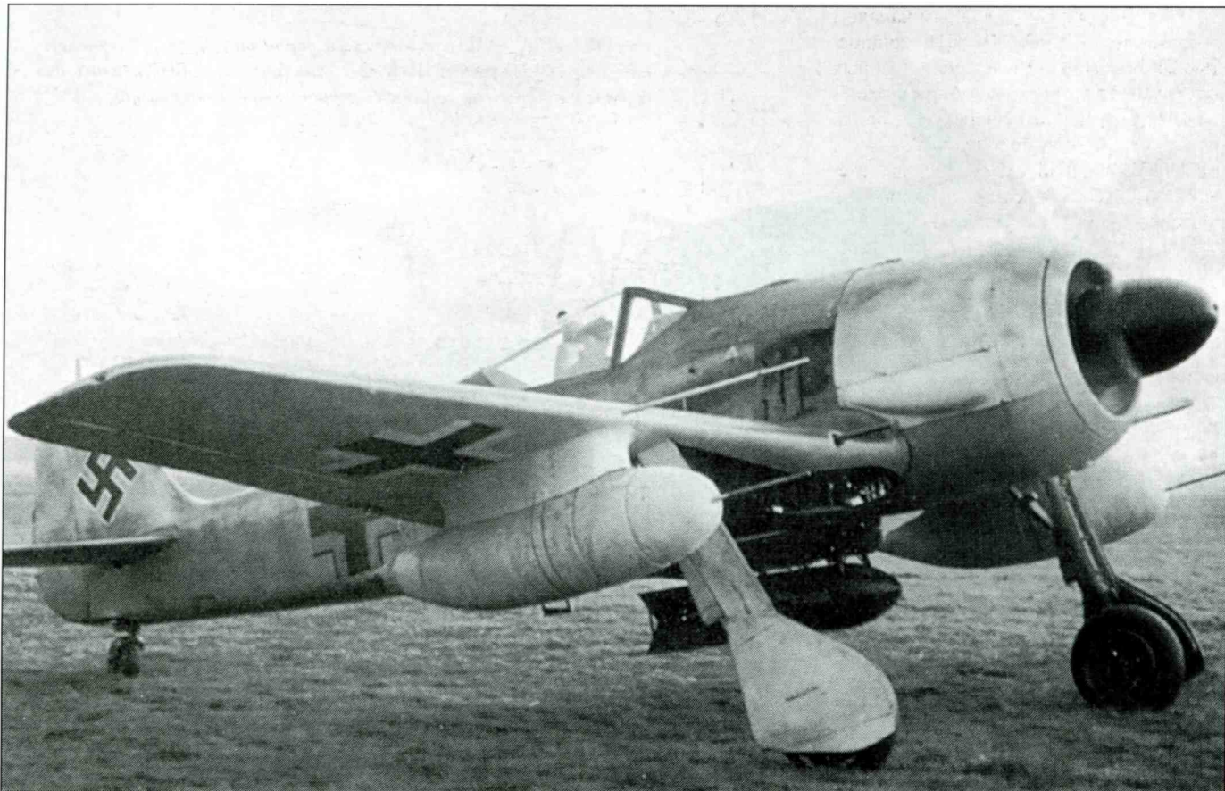
Дальний истребитель-бомбардировщик Fw 190A-4/U8 активно применялся в нескольких частях. Данный Jabo-Rei (Jagdbomber-Reichweite) оснащен под фюзеляжем бомбодержателем ETC 501, а под крыльями установлены два замка типа «Юнкерс» для подвесных 300-литровых баков.
