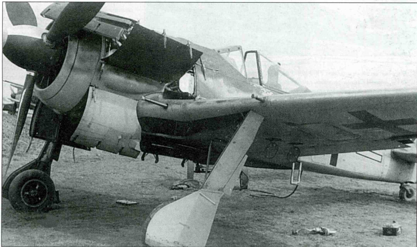
Истребитель Курта Танка отличался отличной эргономикой. Хорошо видно, насколько удобен доступ к двигателю на этом Fw 190A-4/U1/R1. Вариант R1 отличался наличием радиостанции FuG 16ZY с антенной типа «Моран», расположенной под крылом. Фонарь кабины оборудован легким бронезоловьем раннего типа.
