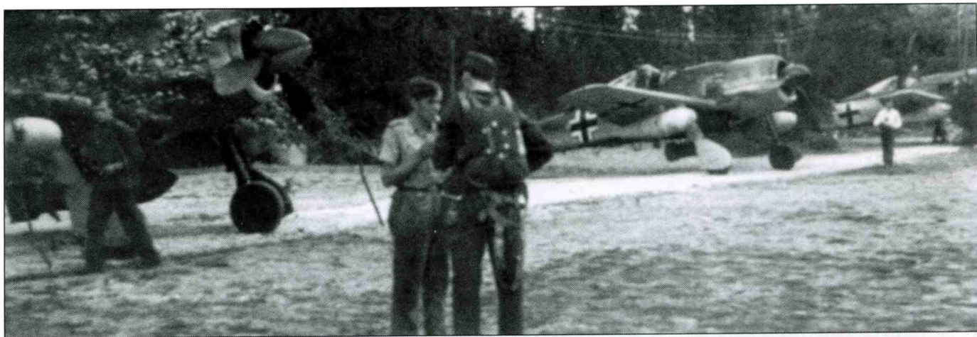
Эти Fw 190A-8 из NSGr 20 оснащены подвесными 300-литровыми баками, подвешиваемыми под крыльями на замках типа «Мессершмитт», 1944 год.
