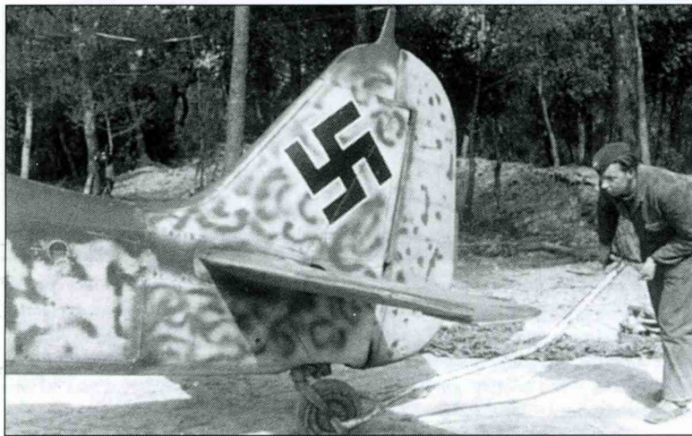
Механик управляет хвостовым колесом буксируемого Fw 190A-4/U4 из 2.(F)/123. Для лучшего камуфляжа желтые элементы быстрой идентификации покрыты темно-серыми пятнами. Хвостовое колесо стандартное - 350x135 мм.
