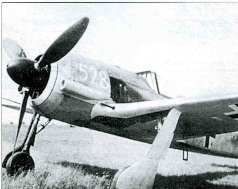
Fw 190A-3/U7 представлял собой высотный истребитель. Большие наружные воздухозаборники обеспечивали повышенный воздушный поток в наддув.
