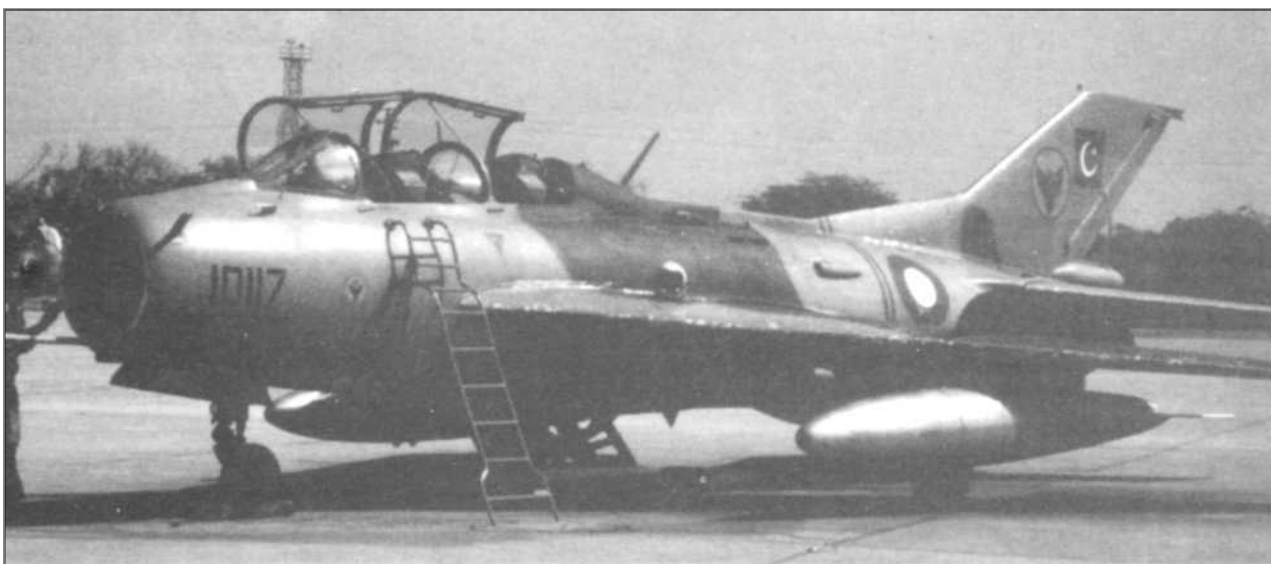
Пакистанский F-6, «10117 черный», принадлежавший 19-й эскадрилье в Марсуре. Антенна на левом борту в носовой части установлена пакистанцами в ходе планового ремонта. Хотя самолет окрашен по схеме, применявшейся на пакистанских F-16, два 760-литровых подвесных бака сохранили цвет натурального металла.
