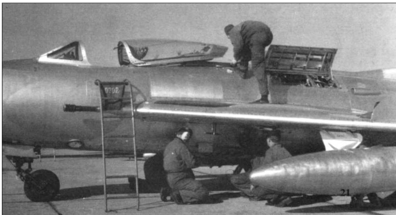
Чешские техники проверяют только что сошедший с конвейера S-105 (серийный номер 50302). Они открыли верхние люки для доступа к двигателям РД-9Б. Этот самолет принадлежит к третьей производственной серии, построенной фирмой Аэро для чешских ВВС в 1960 году.
