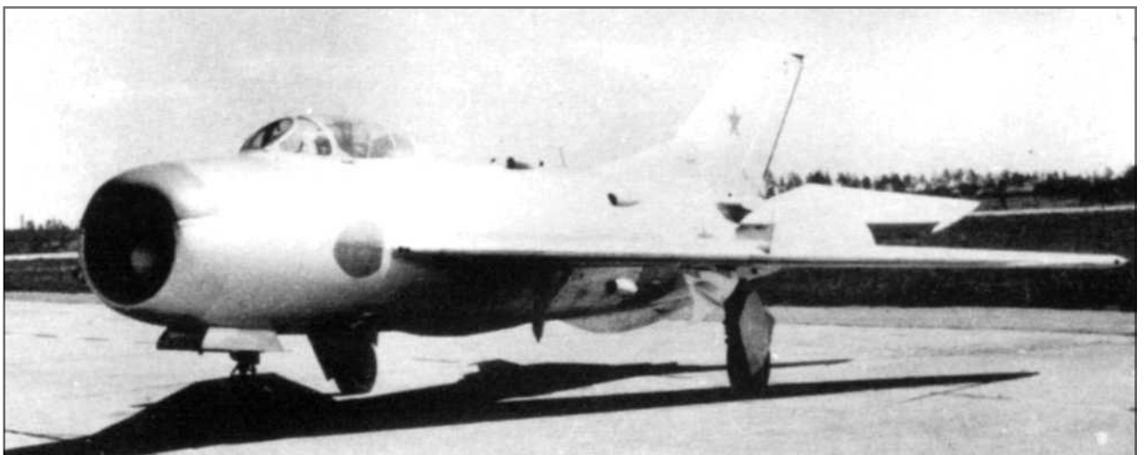
Второй прототип получил обозначение SM-7/2 и отличался от SM-7/1 наличием двух пушек НР-23 в корневой части крыла, с небольшими усиливающими накладками на бортах фюзеляжа, SM-7/2 был оснащён цельноповоротным горизонтальным оперением с балансировочными грузами на законцовках.
