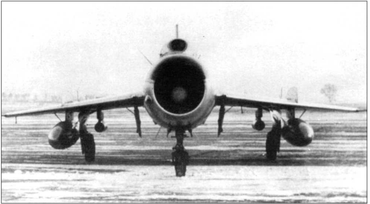
SM-7/1 был оснащён радаром РП-1 «Изумруд-1», расположение антенны которого очень напоминало МиГ-17ПФ. На серийных МиГ-19П обтекатель антенны радара в воздухозаборнике получил коническую форму. Во время испытаний в Жуковском на подкрыльевые пилоны подвешивались контейнеры ОРО-57К.
