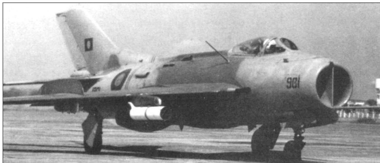
«901 черный» на стоянке авиабазы Читтагонг-Патенга. Все бангладешские F-6 ранее принадлежали ВВС Пакистана. Перед поставкой они прошли ремонт, в ходе которого с них сняли пилоны для ракет «Сайдвиндер». Этот самолет вооружен двумя самозарядными контейнерами для неуправляемых ракет 55ММ. Бортовой номер в носовой части состоит из трех последних чисел серийного номера, который нанесен в хвостовой части.
