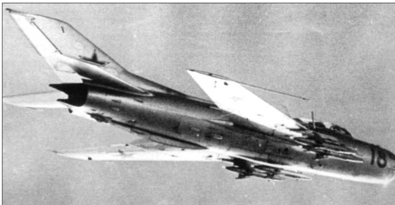
МиГ-19ПМ позднего выпуска из полка ПВО СССР. Самолет оборудован системой предупреждения об облучении «Сирена-2», антенна которой расположена в обтекателе на вершине киля. Система «Сирена-2» устанавливалась только на машинах позднего выпуска, предназначенных для ВВС Советского Союза. Самолет вооружен четырьмя ракетами РС-2У, наводившимися по лучу, которые подвешены на пусковых устройствах АПУ-4. Ракета РС-2У развивала скорость 1650 км/ч и имела дистанционный взрыватель.
