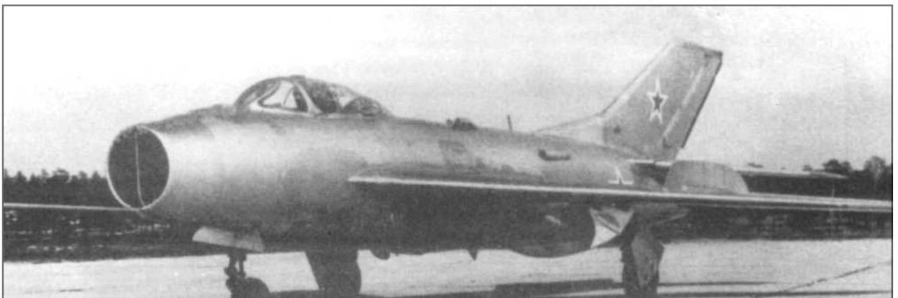
Прототип СМ-2/1 незадолго до начала летных испытаний в Жуковском. Опытный самолет нес 760-литровый подвесной топливный бак, имел катапультное кресло от МиГ-15, триммер на руле и антенну РВ-2 сверху хвостовой части фюзеляжа.
