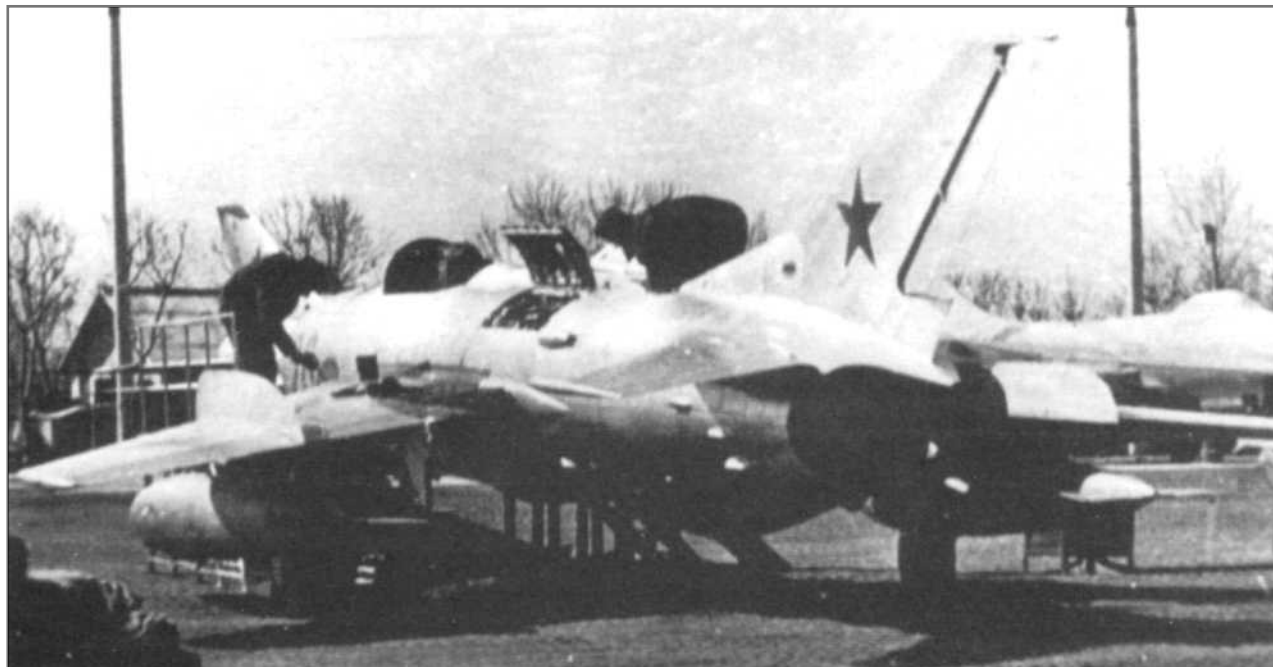
МиГ-19Р, «28 синий», использовался для обучения техников. Сдвижная часть фонаря кабины демонтирована, но катапультное кресло осталось в своем месте. Под крылом самолета подвешены 760-литровые топливные баки.
