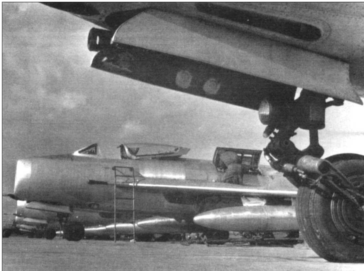
Линейка новых S-105 на стоянке авиазавода Аэро в Водоходах. Под обтекателем, располагающимся на левом борту над отсеком передней стойки шасси, был установлен радиодальномер РД-3 «Град».
