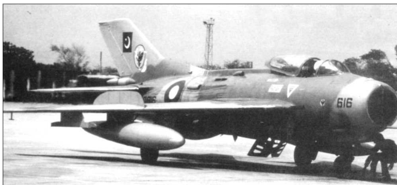
F-6 из 19-й эскадрильи пакистанских ВВС в двухтоновом сером камуфляже. Самолет относится к F-6 позднего выпуска с пакистанскими доработками - мачта антенны снята, установлены пилоны для «Сайдвиндеров». Передний тормозной щиток под фюзеляжем в выпущенном положении.
