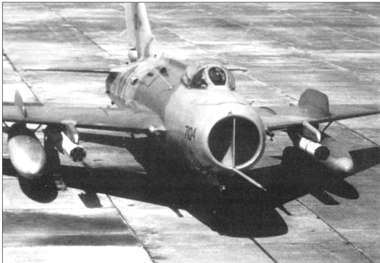
Под крылом бангладешского F-6, «7104 черный», подвешены контейнеры для неуправляемых ракет и 760-литровые топливные баки. Мишина относится к F-6 позднего выпуска с контейнером тормозного парашюта в основании кия и пушками H-30 без дульных тормозов.
