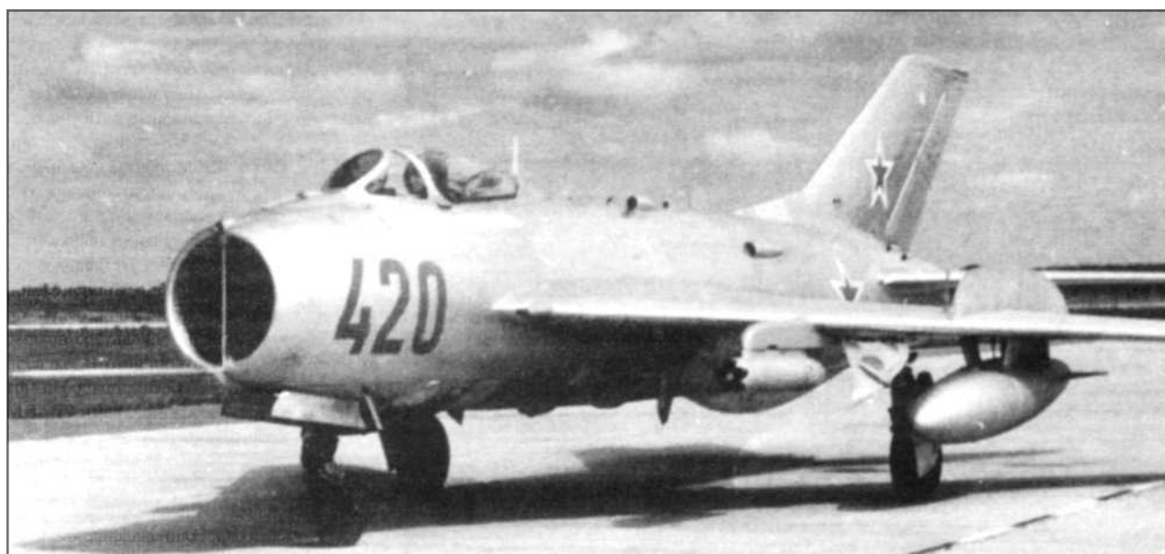
На этот МиГ-19, «420 красный», были установлены пилоны на передней кромке крыла. На них подвешивался блок с четырьмя неуправляемыми ракетами С-5. В авиации Советского Союза такие пилоны никогда не использовались, но они прижились на восточногерманских и китайских МиГ-19.
