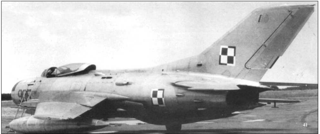
МиГ-19ПМ, «905 красный», польских ВВС на стоянке 28-ого Истребительного полка. К числу отличий МиГ-19ПМ от МиГ-19П относились удлиненный форкиль, штыревая антенна на киле и триммер на руле направления.
