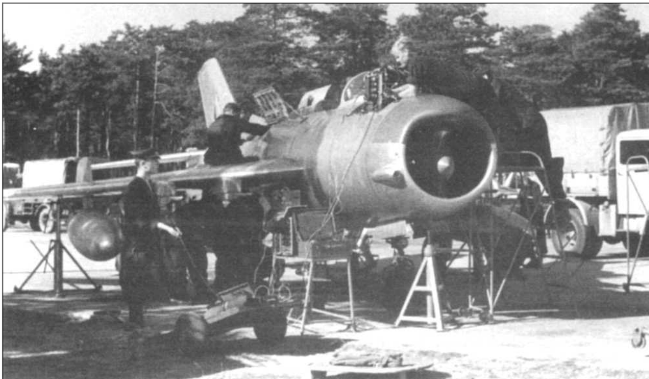
На установленном на домкратах МиГ-19ПМ, «391 красный», ВВС ГДР техники проверяют радар. Стойка с испытательным оборудованием установлена рядом с носовой частью. Параллельно с тестированием радара техники проверяют другие системы самолета.
