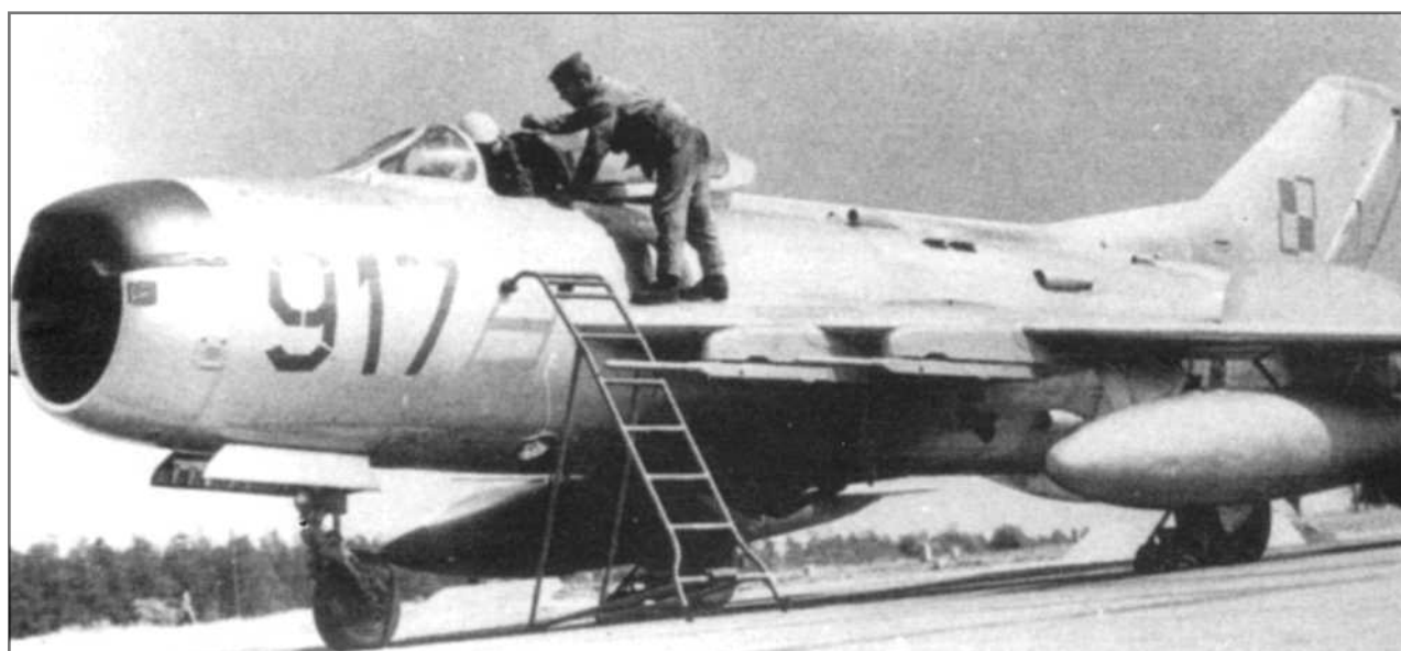
Польский МиГ-19ПМ, «917 красный», готовится к вылету на аэродроме Слупск-Редзиково, расположенном рядом с побережьем Балтики. Все польские МиГ-19ПМ несли красные трехзначные бортовые номера. В учебных полетах на самолет устанавливались только пусковые устройства АПУ-4, а ракеты не подвешивались в целях безопасности.
