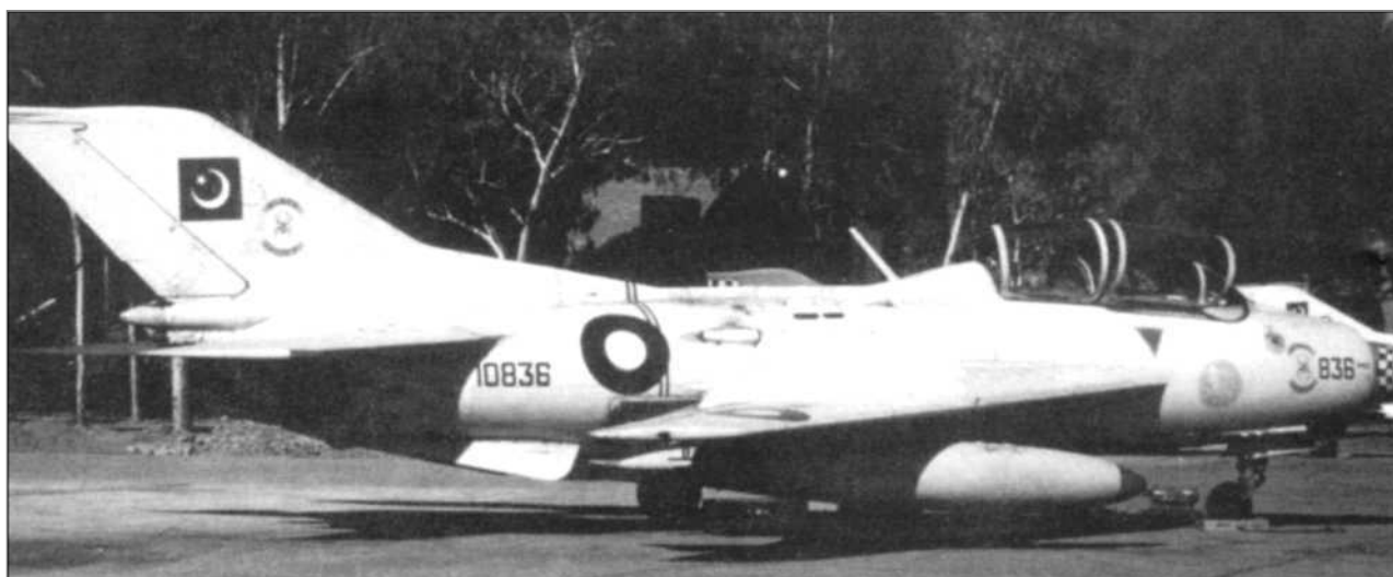
FT-6, «10836 черный», - единственный самолет такого типа в 26-й эскадрилье, базировавшейся в Пешаваре. Это подразделение было вооружено штурмовиками A-5 Fantan и использовало FT-6 для переучивания и совершенствования летной подготовки пилотов. На FT-6 фонарь откидывался на правую сторону, в то время как на F-6 он сдвигался назад.
