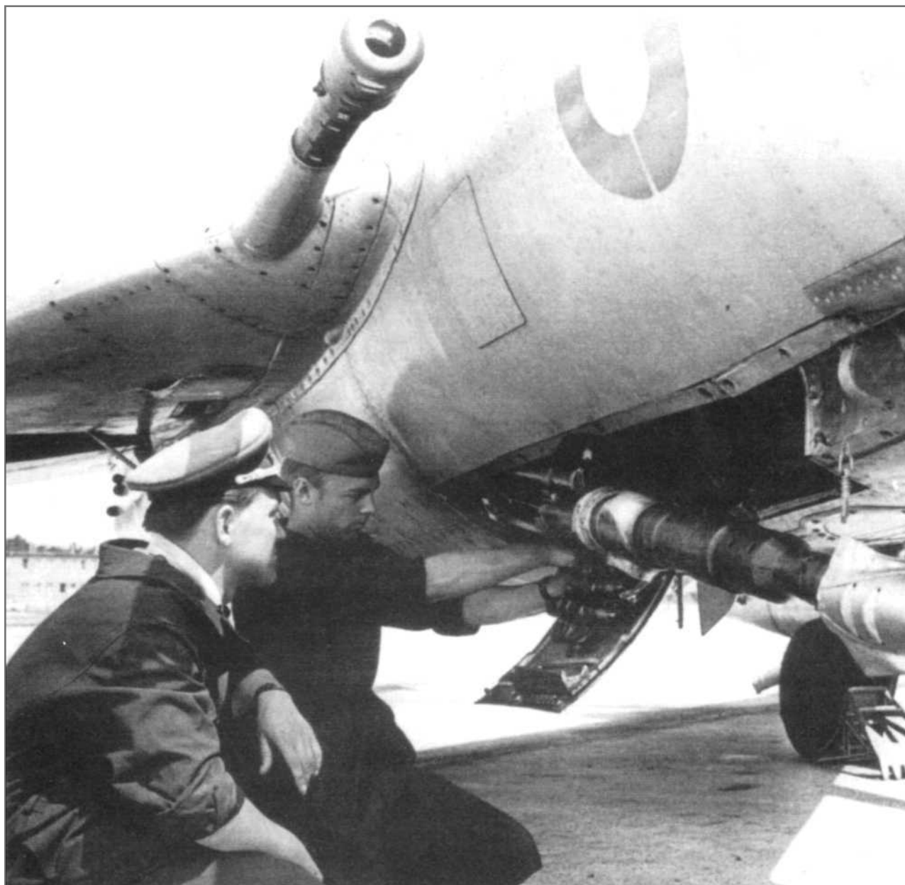
Для простоты обслуживания пушка НР-30 по правому борту фюзеляжа могла быть опущена после снятия прикрывающей ее панели. Большая усиливающая панель на этом восточногерманском МиГ-19С «844 красный» была снята, ее заменили два квадратных газоотражателя.
