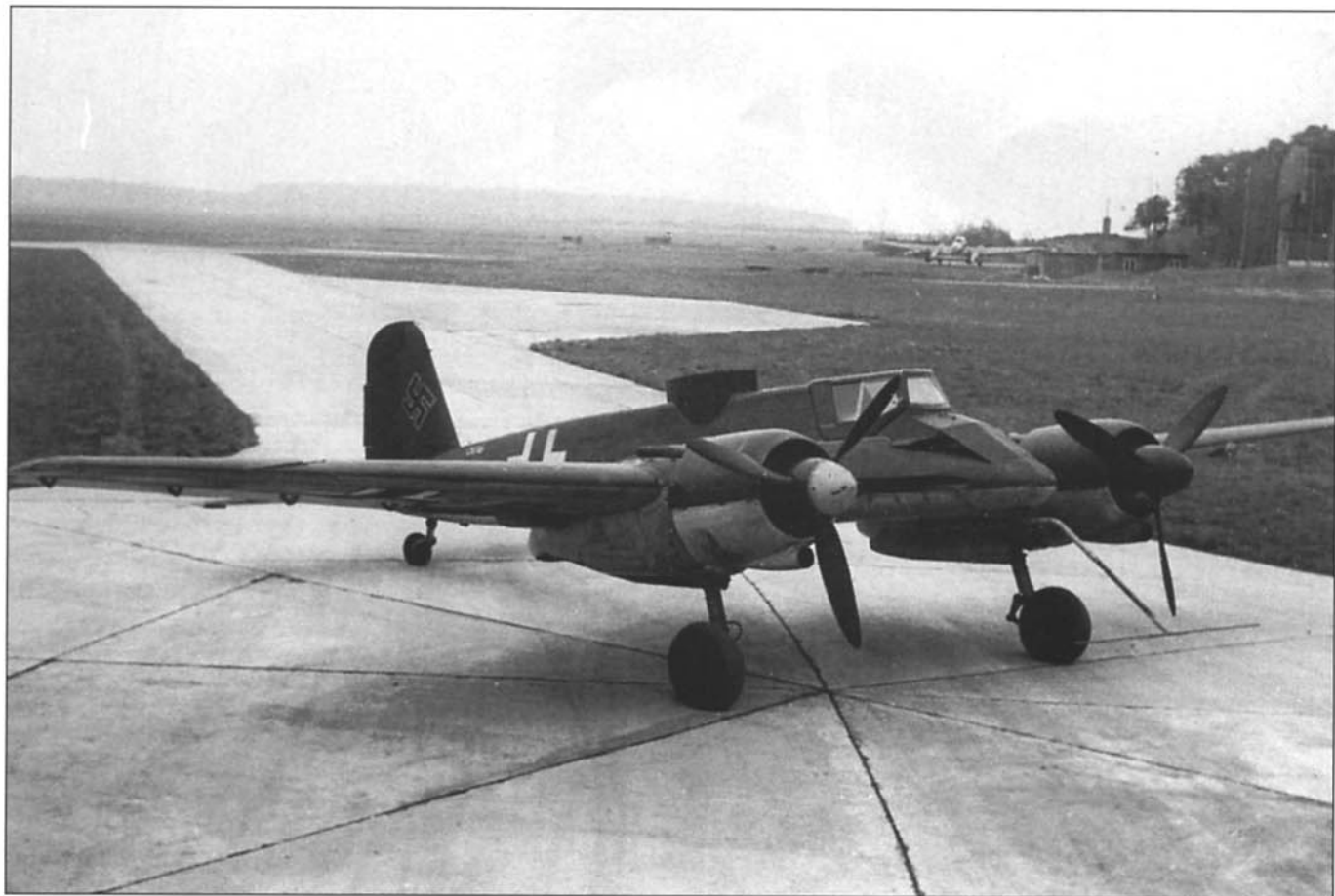
После производства малой предсерийной партии А-1, оснащенных двигателем «Аргус» As 410, «Хенцелю» была заказана партия истребителей с французскими двигателями «Гном-Рон» 14М 04\05, получивших обозначение В-0. Характерным отличием этих самолетов была другая конструкция фонаря. На фото первый самолет этой серии (W.Nr.0016, KK+VI). Обратите внимание на Т-образную антенну, смонтированную в носу и миномет SG 113А. Интересно, что на заднем плане можно рассмотреть его конкурента - Fw 189.
