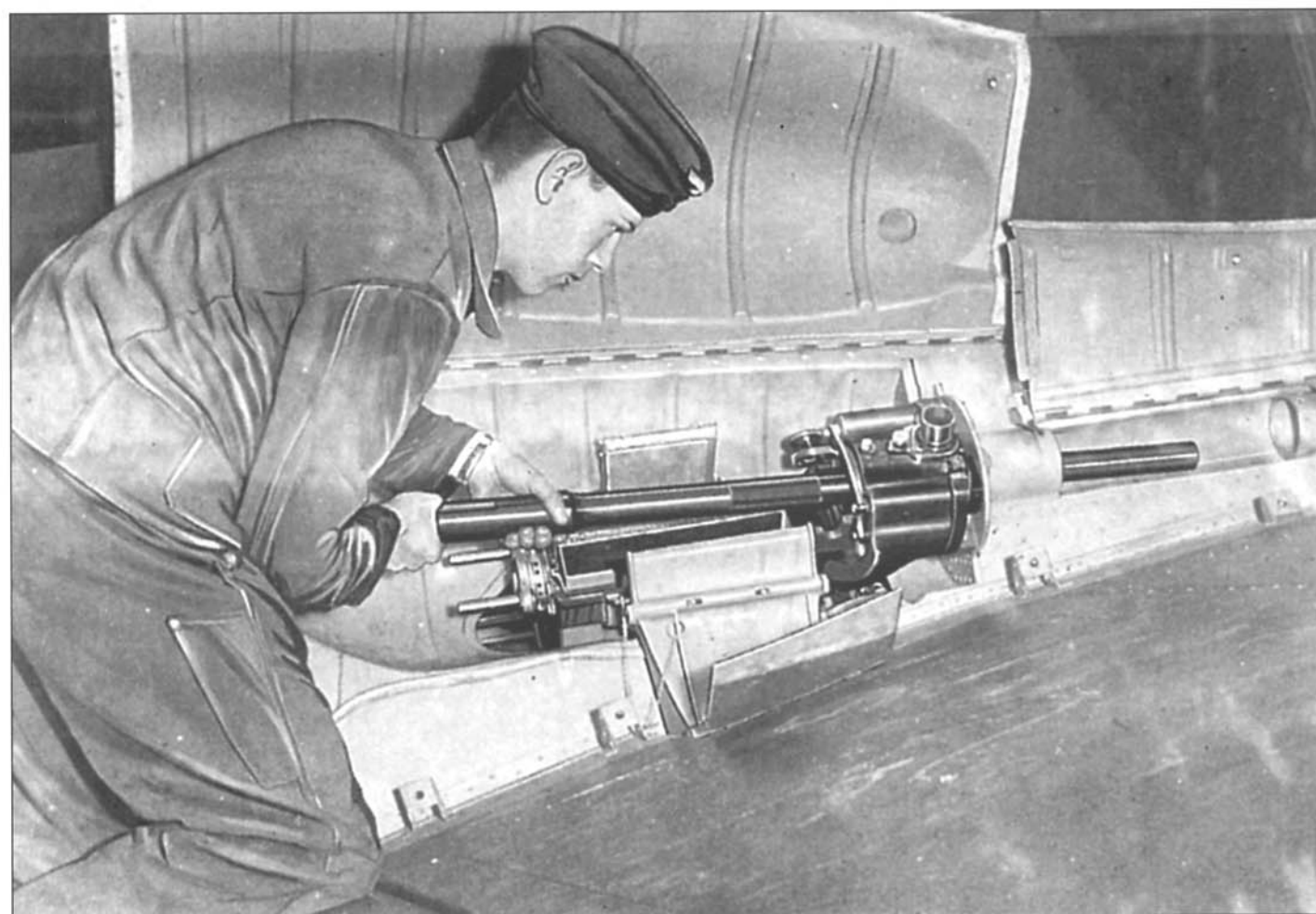
Четыре фотографии, которые показывают установку 20-мм пушки MG 151
