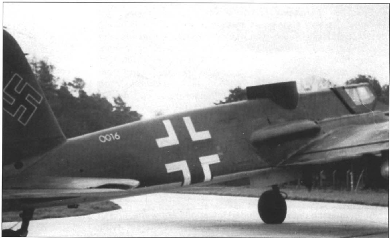
Еще одна фотография W.Nr.0016 с горизонтально стреляющим минометом SG 113А. Обратите внимание на то, что радиокод не нанесен на привычном месте.
