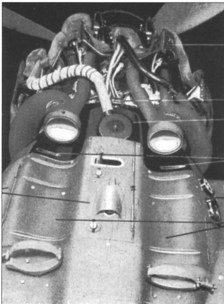
Раскапотированный двигатель: 1 - разъем отъема капота; 2 - скрытая панель; 3 - нижняя часть капота двигателя; 4 - верхняя часть капота; 5 - выхлопные патрубки; 6 - крепежные узлы; 7 - верхняя часть внутреннего капотирования; 8 - нижняя часть внутреннего капотирования.
