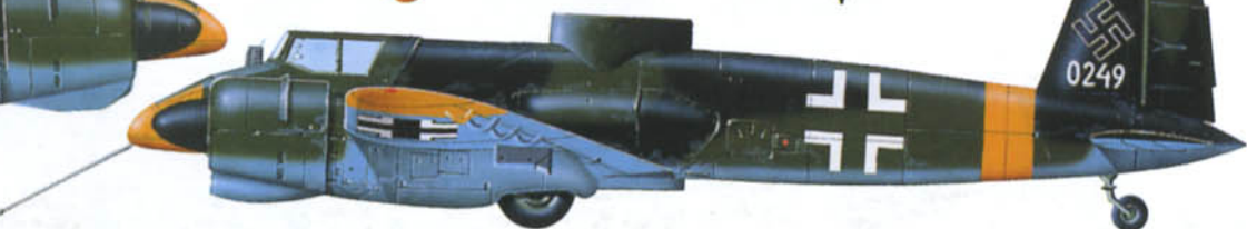
Hs 129B-2 №0249, вооруженный противотанковой ракетной установкой SG 113A, 1944 г.
