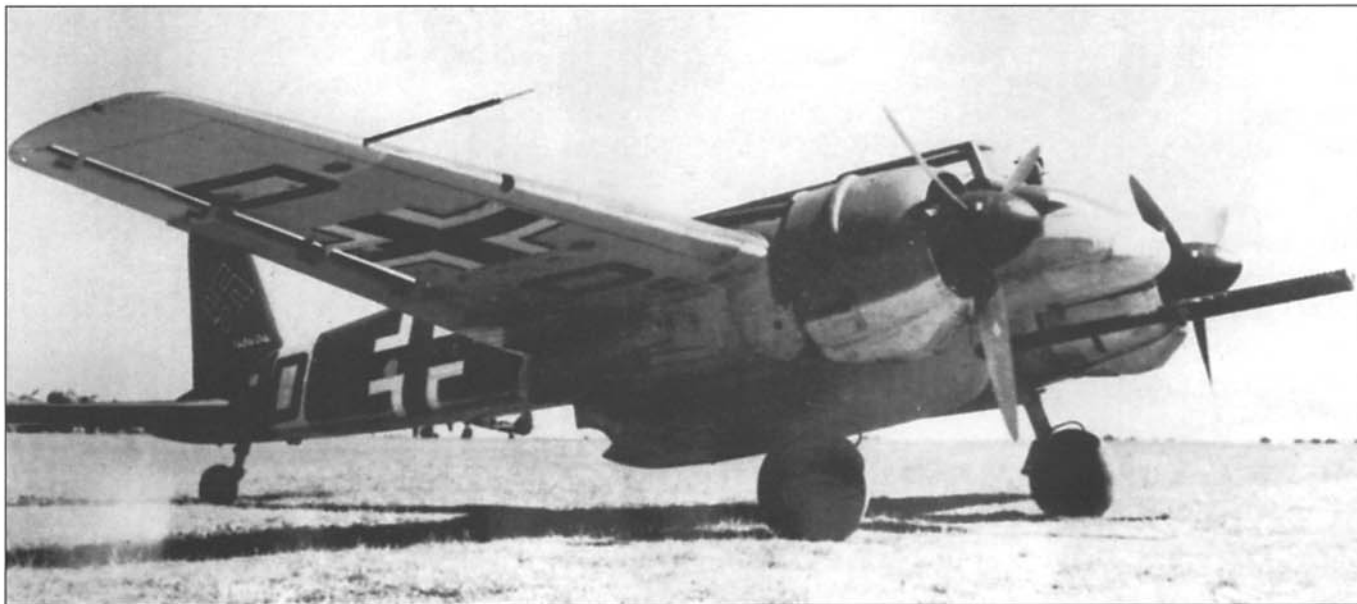
He 129B-2, W.Nr. 140494, код DO+XG - первый самолет модифицированный по стандарту B-3 с 7.5 см пушкой. Самолет проходит испытания в Рехлине в июне 1944 года. Передан в центр по испытанию вооружений в Тарневице 8 июля 1944 года.
