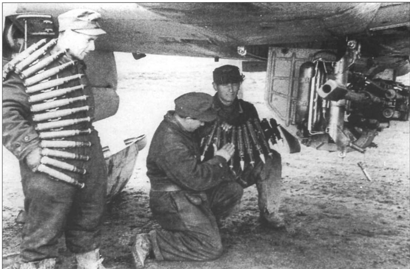
Зарядка пушки МК 103 снарядами в полевых условиях. Снаряды такой пушки пробивали броню в 75 мм на дистанции в 300 метров. Сама пушка в полуопущенном положении.
