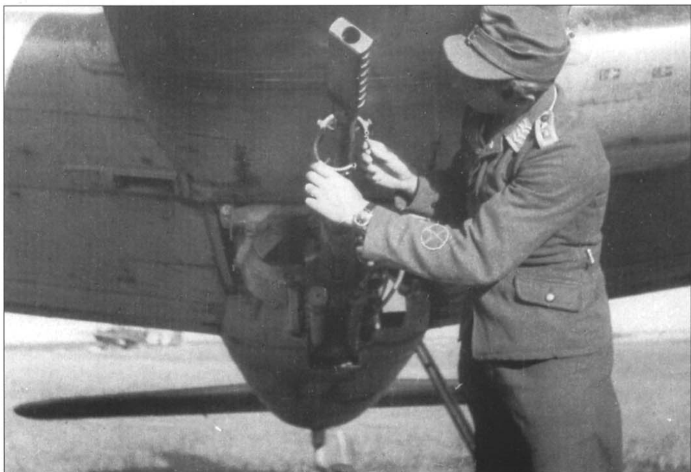
Обслуживание пушки МК 103 неизвестным обер-фельдфебелем. В руках у нее узел крепления пушки.
