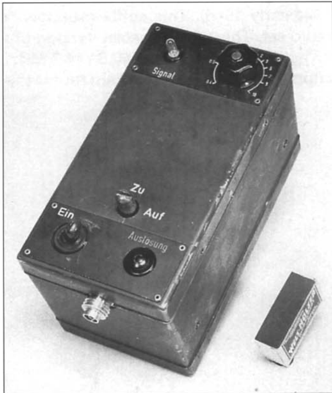
Радиоактиватор миномета, рядом для сравнения - спичечный коробок.
