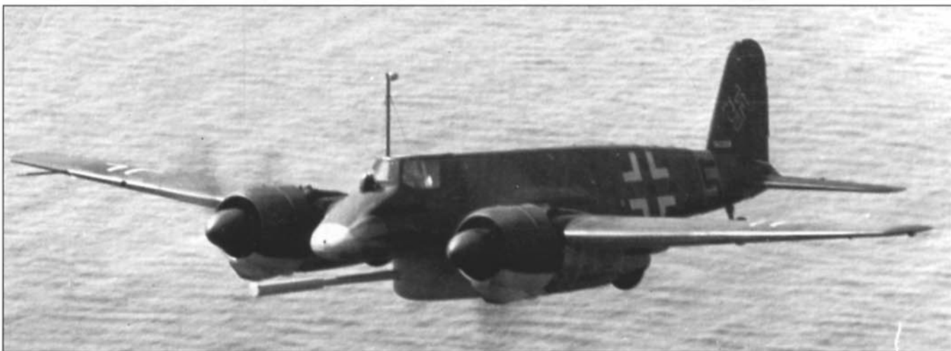
Два фото Hs 129В-2, W.Nr. 141258 код ВН+ZС с деревянным макетом PaK 40. Самолет использовался для испытаний самой возможности применения такой пушки на штурмовике. На фотографии самолет над Балтийским морем. Обратите внимание на переднюю мачту для установки аппаратуры фиксирования результатов.
