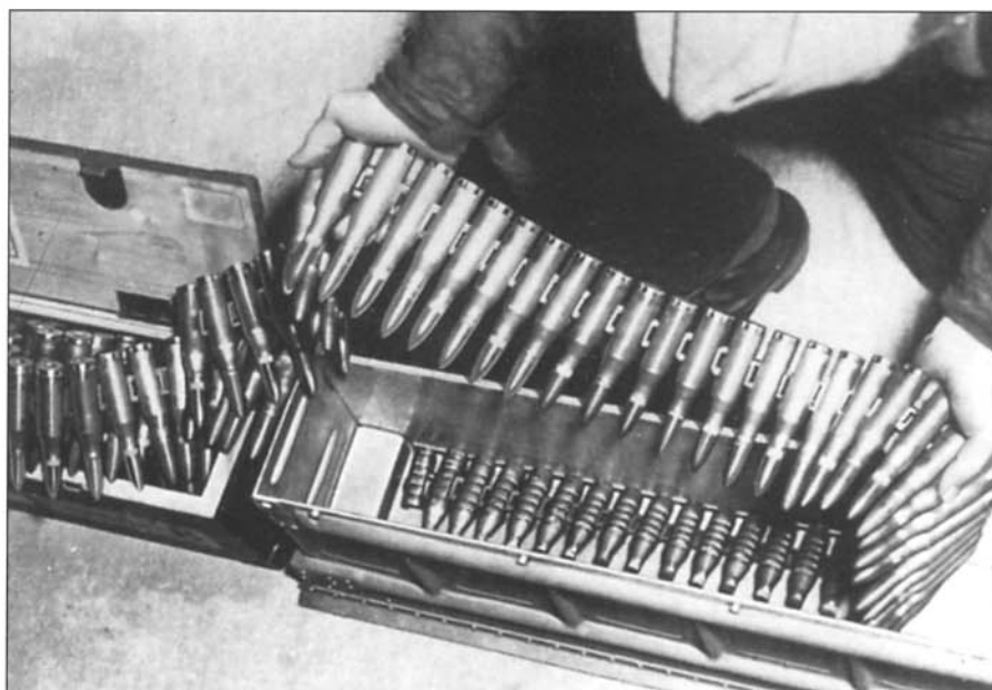
Оружейник укладывает ленту MG 151
