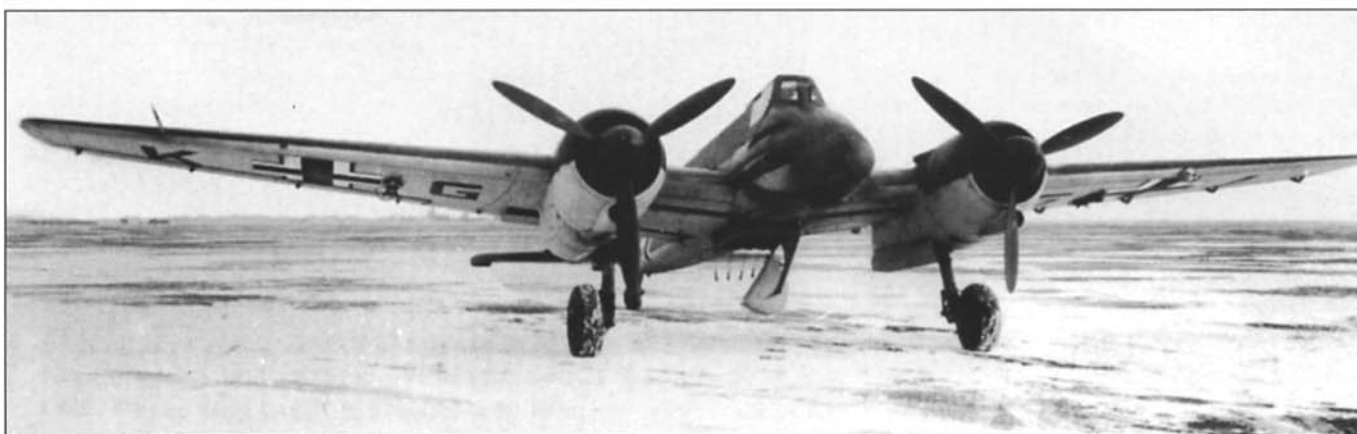
Экспериментальная установка четырех 7.92-мм пулемета MG 17 с 1000 патронами на каждый ствол. Это был первый He 129B-1 (W.Nr. 0151, KG+GI), который использовался для подобного рода испытаний.
