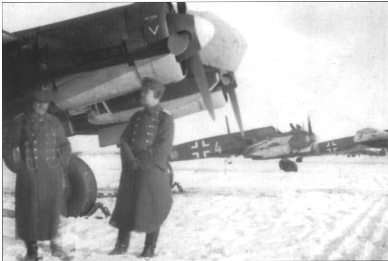
Зимняя фотография: «Желтый 4» вместе с бомбардировщиками Ju 88, аэродром Орша, конец 1942 года. По всем признакам штурмовик модификации В-1. Хорошо видна 30-мм пушка МК 101 и две подкрыльевые подвески для бомб ЕТС 50.
