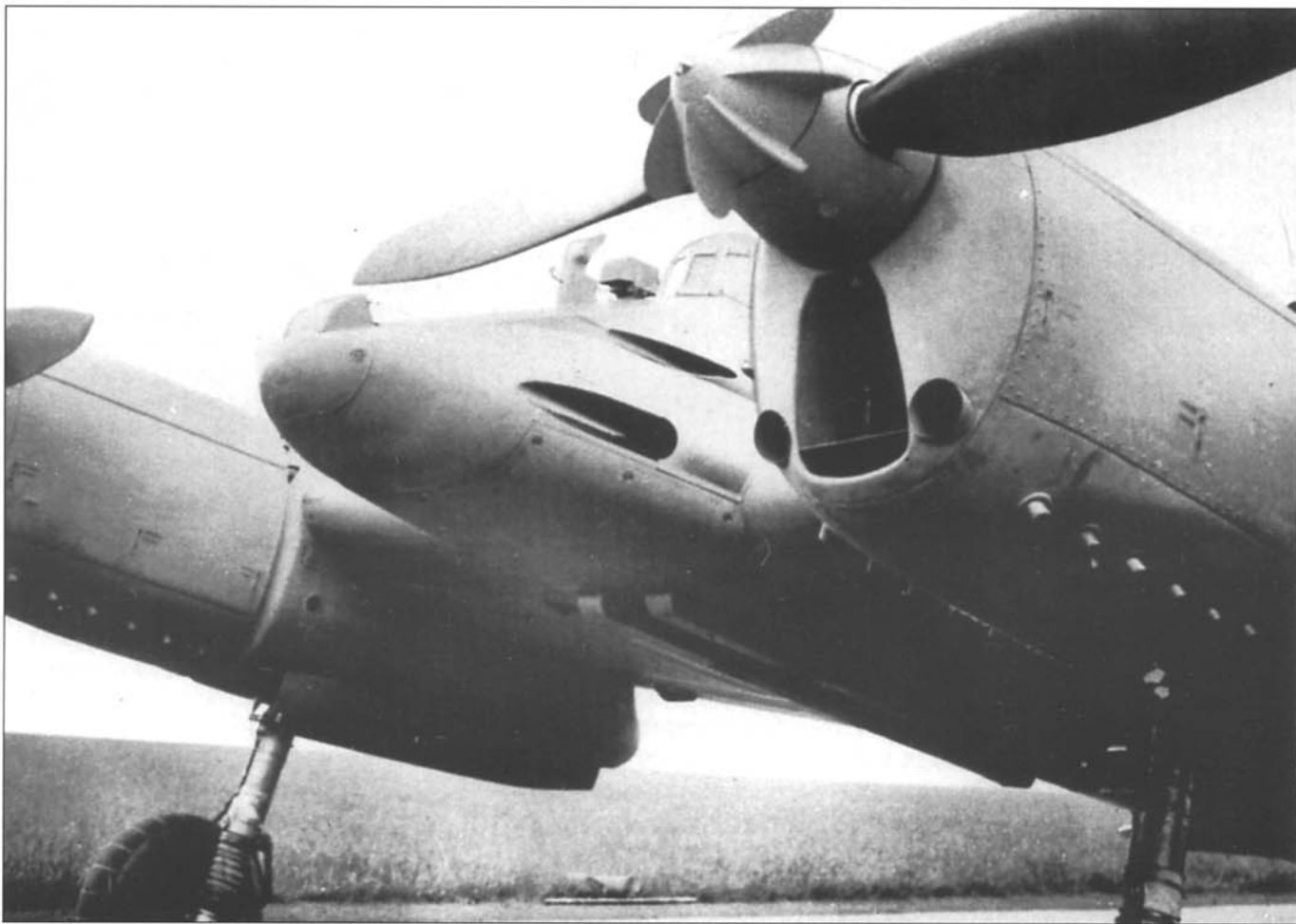
Вид спереди на Hs 129 V-1. Хорошо видны двигатели «Арбус» As 410 и трехсегментный нос. Кроме того, видны подфюзеляжные бомбовые подвески. Все эти детали были изменены в предсерийных машинах.
