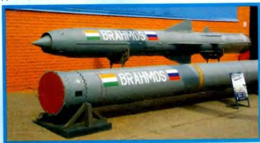
«БраМос» Противокорабельная сверхзвуковая крылатая ракета (Россия–Индия) Дальность полета до 300 км
