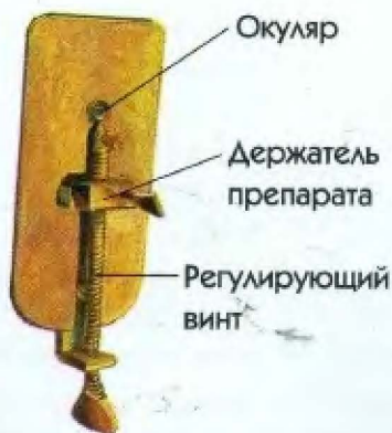
Микроскоп Левенгука состоял всего из одной линзы.
