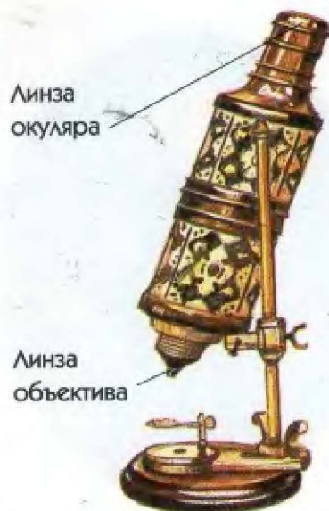
Этот микроскоп, состоящий из двух линз, был сделан около 1675 года. Примерно таким же инструментом пользовался Роберт Гук.
