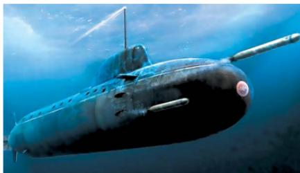
лодок — обтекаемый «каплевидный» корпус и особое ограждение рубки. Однако строение корабля представляет собой в значительной мере отход от традиций советского подводного кораблестроения и приближает «Северодвинск» к американскому типу АПЛ.
