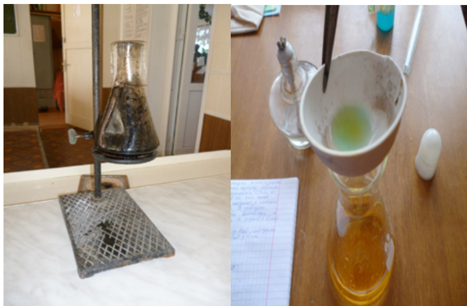
Рис. 2. Выделение сахара из опилок Рис. 3 Качественное определение глюкозы в растворе
