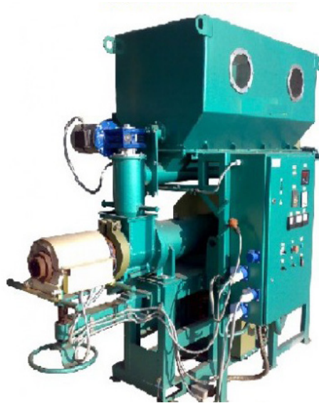
Рис. 9. Вариант экструдера для производства брикетов из биомассы, в том числе и из листьев
