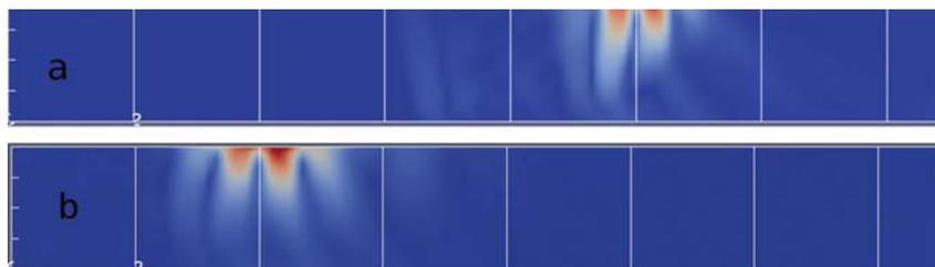
**Рисунок 11.** Распространение волны Рэлея. Два последовательных момента времени 0.2955 с (сверху) и 0.6412 (снизу)
