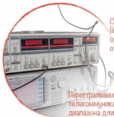
Синхронный усилитель (lock-in amplifier) — позволяет отделять сигнал со СБОМа от шума
