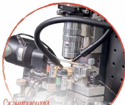
Сканирующий ближнепольный оптический микроскоп (СБОМ) — позволяет измерять локально квадрат напряженности электрического поля световых волн
