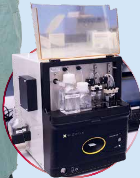
Безмаркерный биосенсор на основе поверхностного плазмонного резонанса. Позволяет в реальном времени наблюдать за протеканием биохимических реакций.
