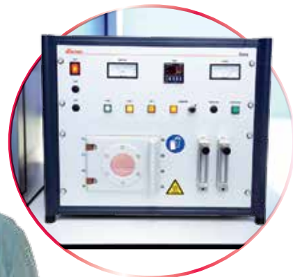
Плазменная установка низкого давления. Используется для очистки поверхностей образцов и изменения их свойств.
