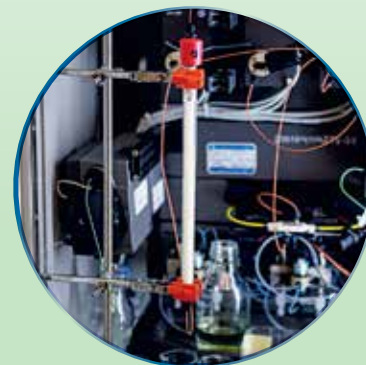
Хроматографическая колонка — используется для разделения белков по размеру и для очистки от примесей
