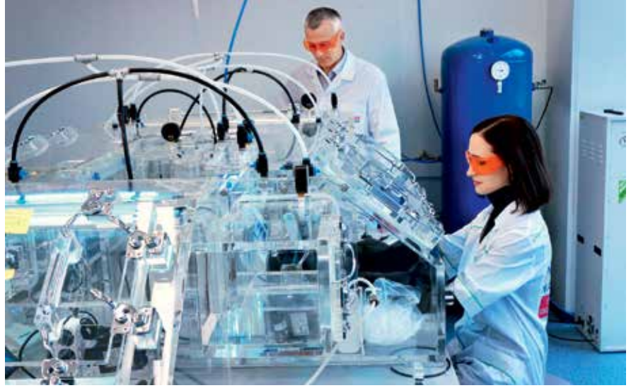
Уникальная система стерильных боксов используется для выделения ДНК из человеческих останков и первой стадии пробоподготовки, на которой необходимо максимально снизить вероятность контаминации
