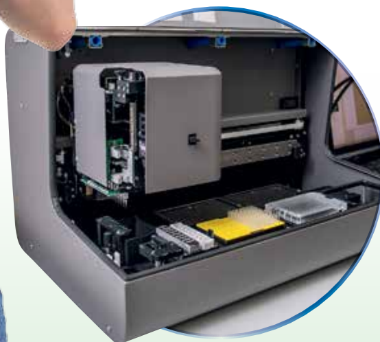
Робот для автоматизированного подбора условий для кристаллизации белков
