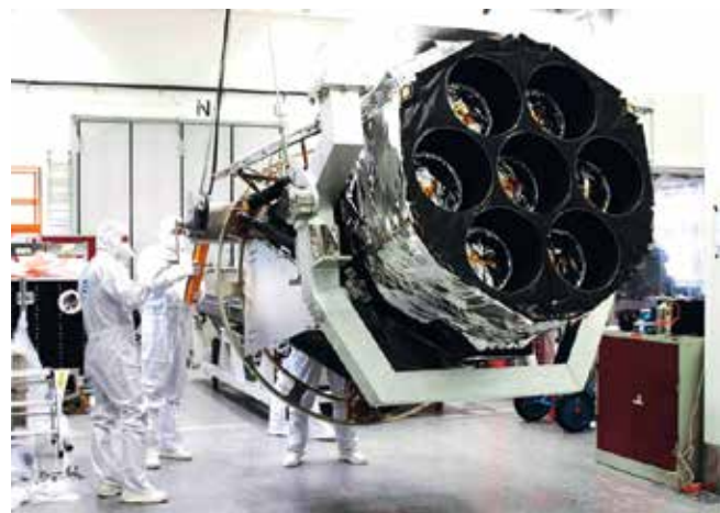
Телескоп eRosita на заключительных этапах сборки в Институте внеземной физики общества Макса Планка
