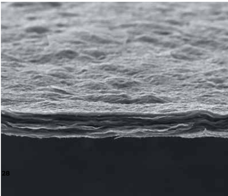
Графен с примесью азота и атомами кобальта. Источник: scitechdaily.com
